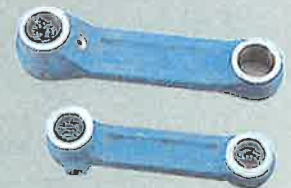
バケットリンク(大)25.1kg (小)3.3kg
