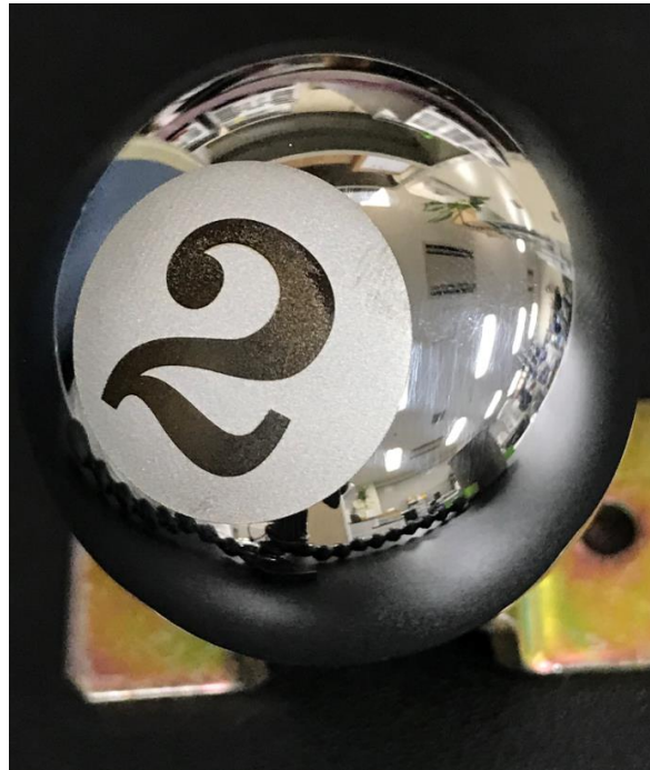
球体形状への歪みのないマーキング =ステンレス材ボール=
