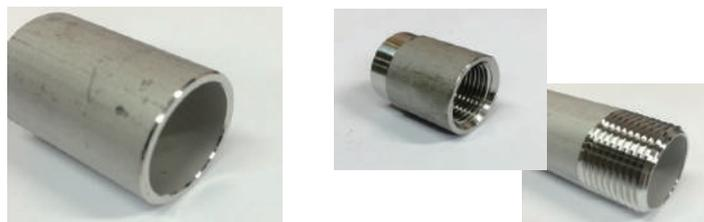
ソケットやボスなどの丸物を加工する際に、パイプから切り出す場合があります。パイプにはシームレスパイプと溶接パイプの2種類があります。パイプを加工で使用の際にどちらのパイプを使うべきか選択する必要がありますが、ほとんどはシームレスパイプが指定されます。しかし、中にはシームレスパイプでなくても要求する仕様を満たす場合があります。シームレスパイプを使用することで過剰品質となってしまう、コストアップとなってしまう。
