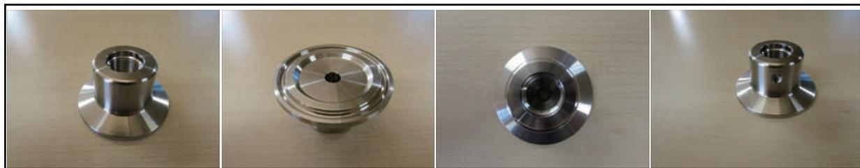
このヘルールは、ステンレス(SUS316L)製の切削加工品で、複合旋盤加工機を使用して加工を行っています。ヘルールの内径ネジと横ネジを同一加工する事により、ネジが交差する部分に発生するバリを最少におさえる事ができるため、人手によるバリ処理の工程が省略する事ができます。また、溝の部分がシール面になっており、表面粗さRa:0.8となっています。
