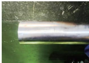
加工で用いる鉄工材料にはSPCCやSS400等の種類がありますが、これらに加えて「黒皮材」や「ミガキ材」等の鋼材の仕上りを指定する必要があります。一般に黒皮材は熱間圧延加工を行い表面が酸化しています。それに対しミガキ材は冷間圧延加工で、きれいな表面に仕上がり寸法精度の高い加工に向いています。加工を行う際にミガキ材で加工するように指定されることがあります。しかし、黒皮材でもお客様の求めている仕様を満たすことができる場合があり、過剰品質となってしまうコストアップになってしまいます。
