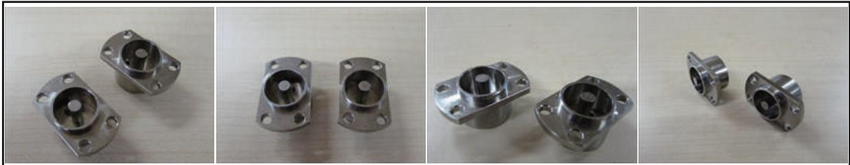
この電極はインバー製の切削加工品で、NC旋盤とマシニングセンターにより加工を行っています。中心部の軸の削り出しを行っており、さらに、内径の底面からツバまでの高さに100分の2というシビアな公差が適用されています。インバーは粘り気があるという特徴があるため、切削屑の絡みや、素材のむしれによって品質が低下しないように注意しながら加工を行っています。
