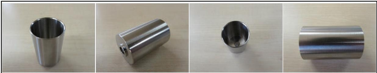
このカバーはインバー製の切削加工品で、NC旋盤により加工を行っています。この製品は内径の底面までが50Lと深く、シビアな公差が適用されています。難削材の1つであるインバーの特徴としては、粘り気があり、局部的に熱がこもることで熱による歪みが生じやすくなります。そのため、切削加工中に切削屑が絡みついたり、素材のむしれが発生し製品の品質が低下するトラブルが発生しがちであるのが、インバーの加工には最新の注意が必要です。
