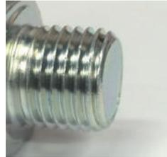
コスト面を考慮すると、旋盤加工ではなく転造加工でネジを製造した方がコストを抑えられる場合が多くあります。転造加工をすることで、旋盤加工に必要なチップ代が削減できるので、その分コストダウンすることができます。しかし、キリネジ指定でしか実現できない仕様もあります。例えば、見た目をきれいにする・シール面のネジを製作する等があげられます。転造加工をする際にはお客様の要求する仕様を満たすかどうかを吟味する必要があります。
