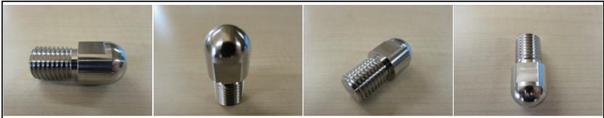
このステンレス(SUS304)製ネジは、NC自動旋盤で完成品に加工している旋盤加工製品です。大量に製作している製品なので効率的に加工するため、NC自動旋盤を24時間体制で稼働させることで、高い生産性のもと、お客様へ供給しています。また、ネジ部は転造機にて加工しているため、大量に加工する事が可能です。そして、装飾ネジの先端部分の球形状は外観部品であるため、バフ研磨にて仕上げ加工を行っています。
