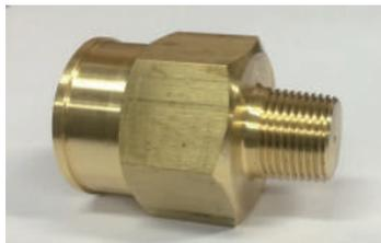
ニッケルメッキを施すと、被メッキ物の耐食性が向上します。しかし、用途によってはニッケルメッキが不適な場合があります。水道管内が錆び付かないようにするために、真鍮のニップルに対してニッケルメッキを施す場合があります。しかし、メッキは長期間の使用することでワークからはがれてしまいます。水道管等でメッキがはがれてしまうと水道水にメッキが混入してしまい、大きなトラブルを発生させてしまいます。
