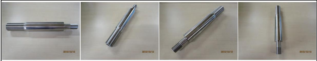
このシャフトはステンレス(SUS304)にて製作した旋盤加工品です。サイズはφ35x300mmの産業用機械に使用されるシャフトです。外径は摺動面のため、研磨仕上げを行い表面粗さはRa:0.4としています。カドクラでは、φ8~φ90までの旋盤加工品を得意としており、上記のような高精度な表面仕上げ加工が必要なシャフトの製作も得意としています。
