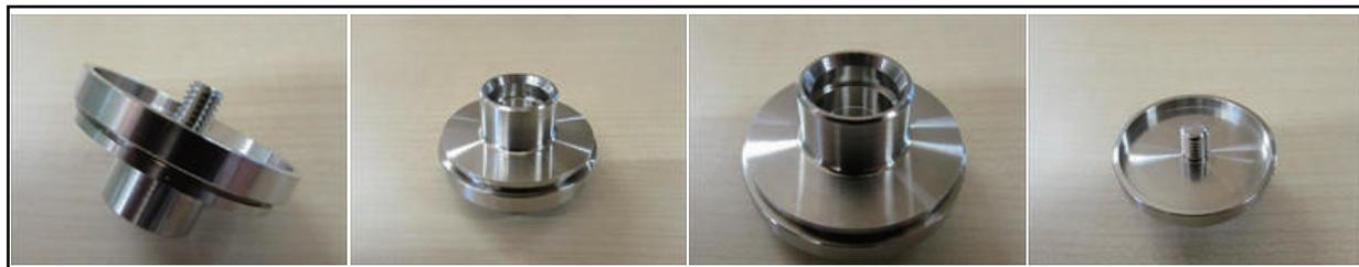
このステンレス製のホルダーは、NC自動旋盤にて加工した加工品です。このステンレス製ホルダーは、ステンレスの特徴である錆びにくく、耐熱性、耐薬品性、耐食性に優れた特性を持っています。また、このホルダーは使用液が漏れてはいけない場所に使用する切削品のため、シール面の表面粗さが重要になってきます。そのため、表面粗さはRa:0.8にて仕上げ加工を行っています。
