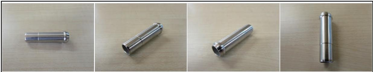
このパイプはステンレス(SUS304)にて製作した旋盤加工品です。先端のバルジ・スプール加工は専用の金型を使用しプレスにて指定の形状に加工していますが、このパイプ自体はNC自動旋盤により全て削り出しにて製作しています。専用の金型を使用せず、NC自動旋盤にて削り出して加工しているため、小ロットのバルジ・スプール加工にも対応できます。
