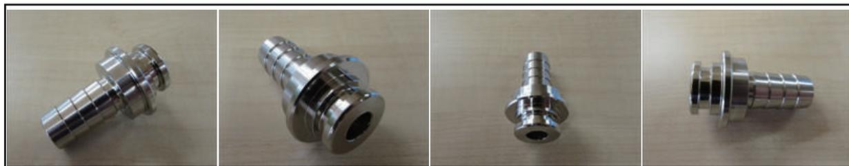
このステンレス製の継手はNC自動旋盤にて加工した加工品です。加工精度は50μmで、食品・飲料業界に使用される、タンクの継手として使用されます。タンクに取り付けられる継手であるので、内容物が外部に漏れないように、シール面の仕上がりが重視されます。そのため、表面粗さRa:0.8にて仕上げ加工を行っています。
