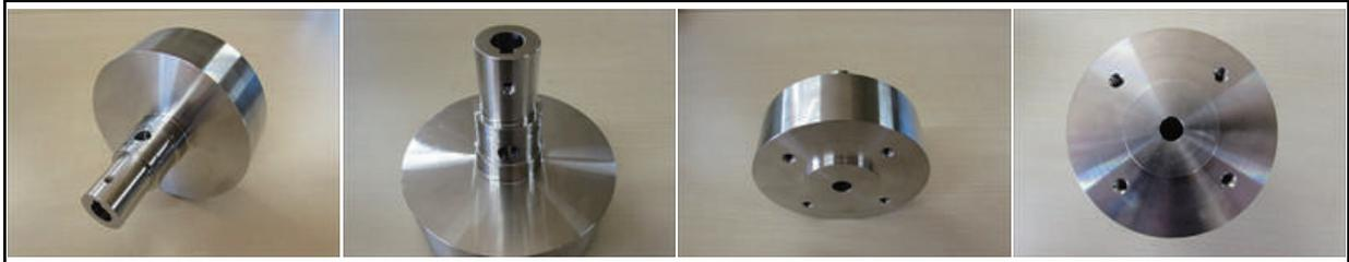
この回転軸はステンレス(SUS303)にて製作した切削加工品です。複合旋盤加工機を使用することにより、端面穴や横穴を同時に加工し、効率的に生産を行っています。回転軸の外径と内径の同芯度が重要な製品であるので、高い精度の同芯度を出すために同時加工にて製作しています。また、キー加工はブローチ盤にて加工を行っています。旋盤をはじめ、ブローチ盤など、豊富な加工設備を保有する株式会社カドクラでは、あらゆる形状の量産加工にも対応することが可能です。
