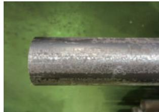
旋盤加工で用いる鋼材をミガキ材から黒皮材に変えることで30%~40%程度コストダウンすることができます。黒皮材とミガキ材を比較すると、高価な分ミガキ材のほうが表面の精度が高くなるので高品質の製品を加工することが可能です。だからこそ、お客様の要求する仕様に合わせ最適な材料で加工をすることで、コストダウンにつながります。ミガキ材を指定された場合でも、お客様の要求する仕様と照らし合わせ、黒皮材でその要求を満たせる場合は黒皮材で加工することで大幅にコストダウンすることができます。
