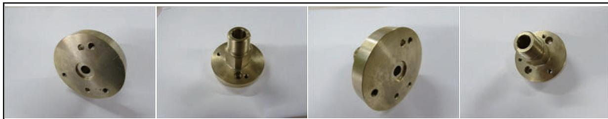
この継手はフランジ付きの継手で、真鍮にて製作を行っています。加工は複合機を使用し、旋盤加工とマシニング加工を同時に行うことで、効率的な生産に対応しています。段付きになっている面がシール面となっており、表面粗さはRa:0.8となっています。真鍮の旋盤加工は、ステンレス加工に比べて加工性に優れているため、量産の旋盤加工にも向いています。
