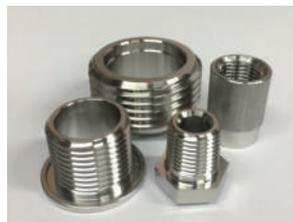
特注のパイプから削り出し、段付き加工などを行うことで、ソケットやボスなどの旋盤加工品をコストダウンすることができます。もちろん市販の規格品パイプで対応できる場合には規格品を活用した方がよいです。しかし規格品パイプで対応できない場合であっても特注パイプを使用した方がコストダウンできる場合が多くあります。特に薄肉の旋盤加工品の場合には丸棒からの削り出しよりも、特注パイプからの製作の方がコストも安く納期も短いといったケースがあります。
