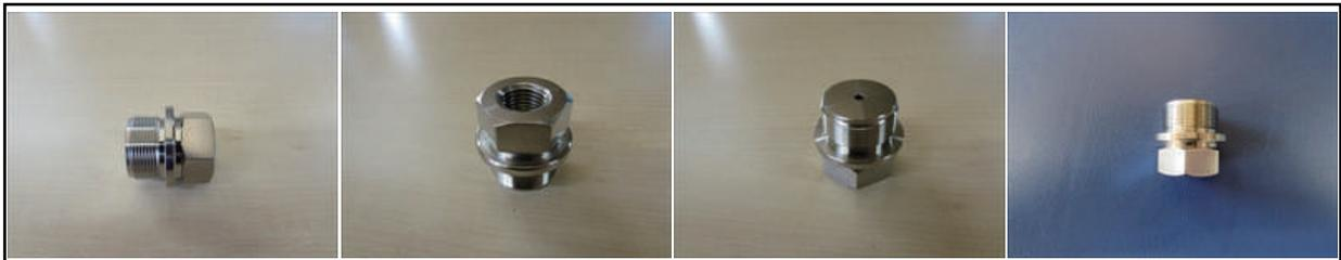
このステンレス製のソケットは、NC自動旋盤とマシニングセンターにて加工した切削加工品です。ソケットの溝部分がシール面となっているため、シール面の仕上がりが重要であり表面粗さRa:0.8にて仕上げ加工を行っています。丸物・旋盤加工.COMでは、 $\phi$ 8~ $\phi$ 90までの小型の旋盤加工品の製作を行っています。溝切りやねじ切り加工をはじめ、あらゆる旋盤加工品の製作に対応しています。
