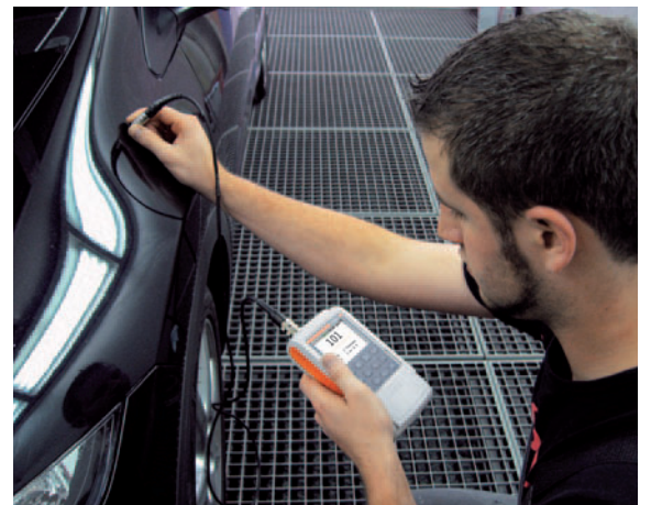
ペイント厚の測定：両方式プローブFD13Hを使用
