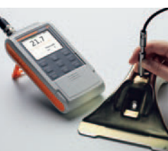
DELTA SCOPE® FMP10 とプローブFGAB1.3 : Fe上のZn測定
