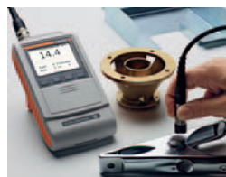
DUALSCOPE® FMP40 とプローブFD13H : さまざまな小型部品測定
