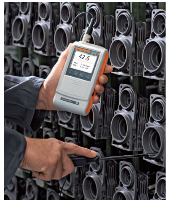
内壁用プローブFAI 3.3-150を使用している測定
