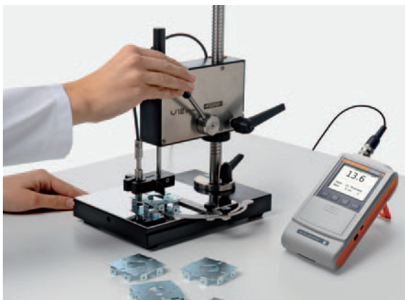
DUALSCOPE® FMP40とプローブFGAB1.3にサポートスタンドV12 BASE : 高精度な位置決めで円筒状の部品を測定
