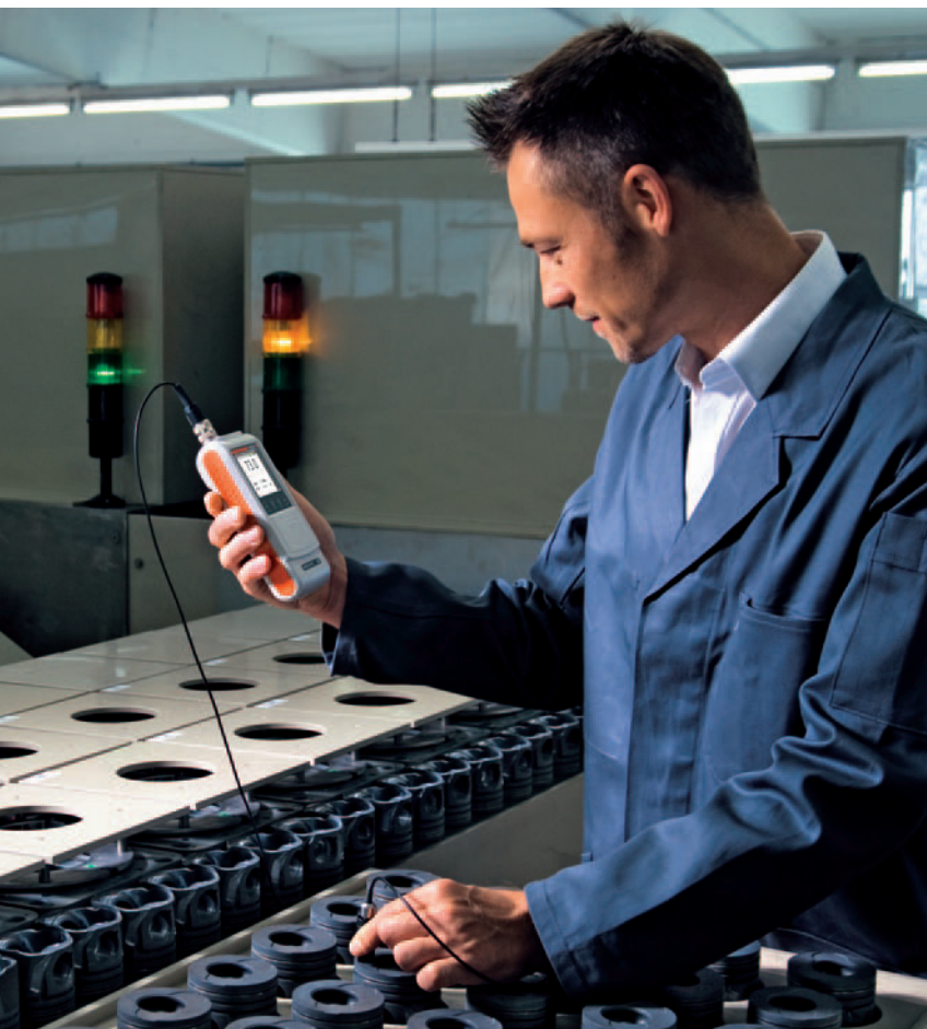
製造直後のエンジンピストンの品質検査：FTA3.3Hプローブ使用
