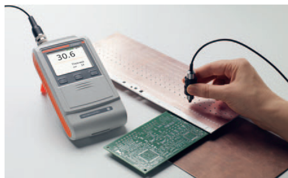
ISOSCOPE® FMP10とプローブFTA3.3-Cuを使用し PCB上のCuメッキ厚測定
