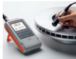
DELTA SCOPE® FMP30 とプローブV7FKB4 : ブレーキディスクの測定
