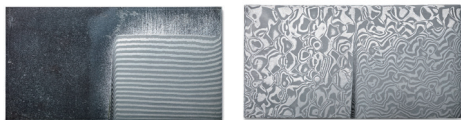
エッチング後の模様の一例 【左：積層材のまま / 右：エンボス加工後】
