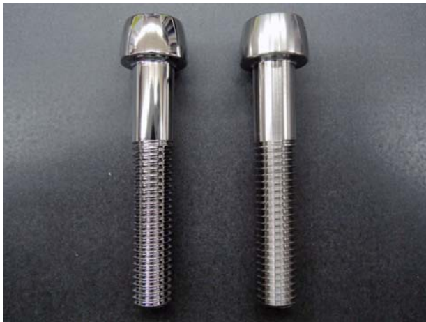
電解研磨後 電解研磨前
