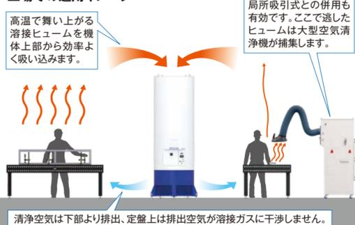
清浄空気は下部より排出、定盤上は排出空気が溶接ガスに干渉しません。
