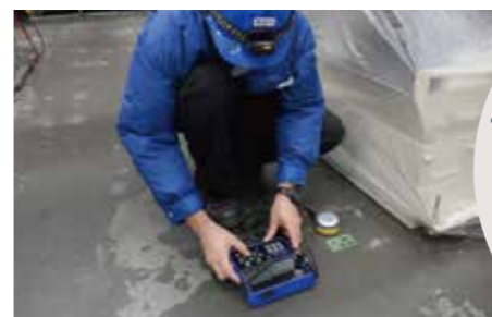
施工後にコンクリート振動測定/30dB~90dBを測定
