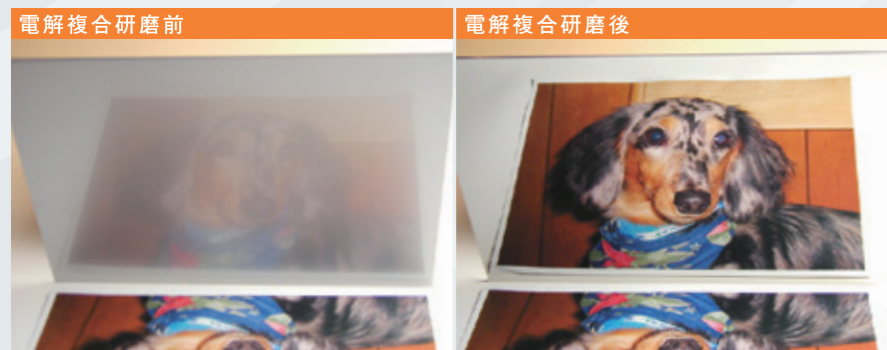
■ Ra（算術平均粗さ）0.001 \mu m（1nm）。前に置いた写真が映っています。
