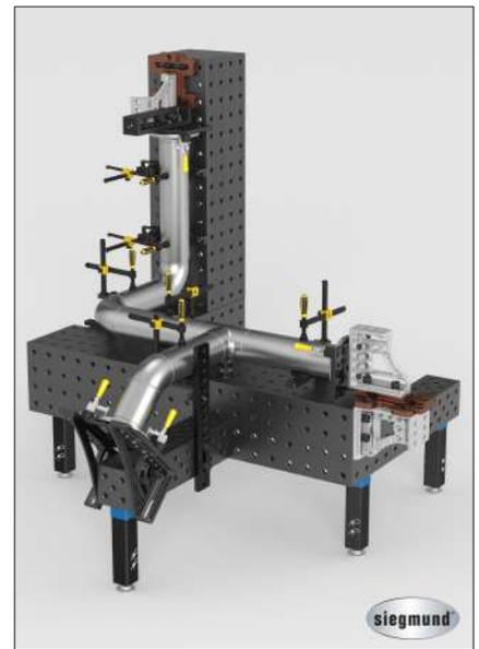
ロボット溶接向けの八角定盤や移動昇降式テーブル
